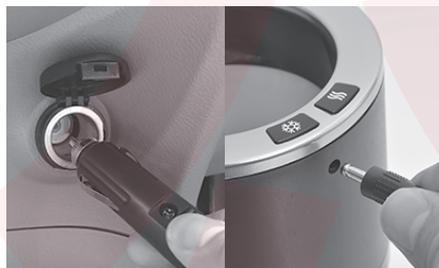
①シガーケーブルをソケットにさして、もう一方を本体電源口にさします。
