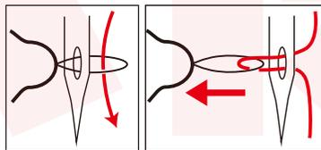
糸通しを針穴に差込み、糸通しの穴に糸を通す。糸通しを針穴から引き抜くと、穴に糸が通ります。
