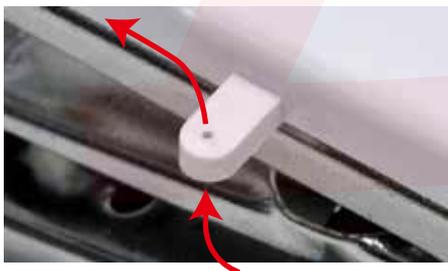
② 糸調子ダイヤルに糸を挟み込みます。パネに巻き付けないようにしてください。縫っている時に、糸が引つ張られるもしくは緩すぎる場合は、このダイヤルで糸の張りを調整してください。
