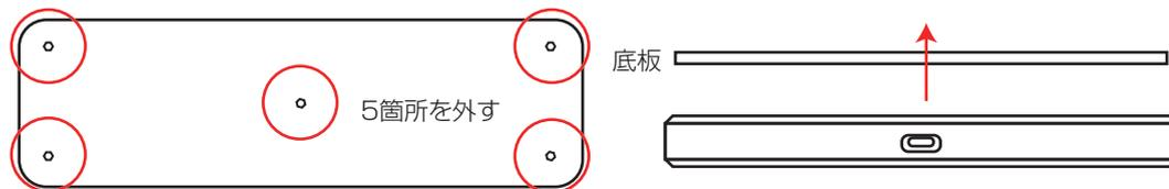
②本体の上下を返し、基板を取り出したらボタン電池を新しい電池と交換します。
