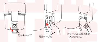
②スイッチの位置がオンの場合は オフに切り替えます。 ③電源プラグの先に付いている キャップを外し、コンセントに 電源プラグを差し込みます。
