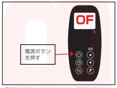
①電源ボタンを押します。電源が切れ、 リモコンに「OF」と表示されます。
