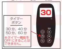
タイマーボタンを押すと、電源 OFF の時間調整ができます。押す たびに30,40,50,60分と 設定時間を変えることができます。 タイマーの初期設定は30分になっ ています。
