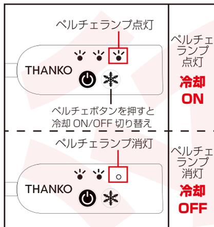
⑥ペルチェ冷却を ON/OFF する場合は、ペルチェボタンを押してください。押すたびに ON→OFF→ON…と切り替わります。
