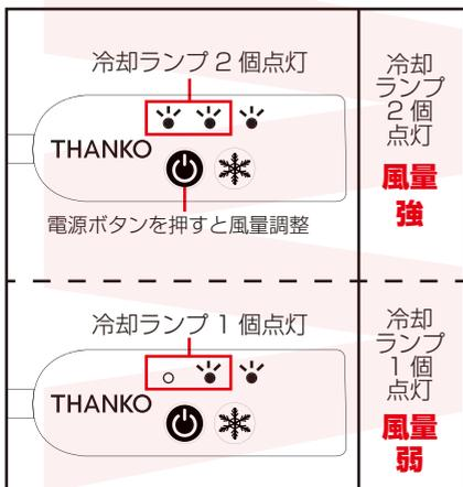
⑤冷却調整をする場合は、電源ボタンを押してください。押すたびに強→弱→強…と切り替わります。
