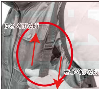
②着用した状態で左右のバックル紐の長さを調整し、きつくしたり、緩めたりしてください。
