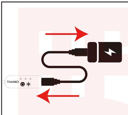
②リモコンに付属の USB ケーブルを接続し、モバイルバッテリー（別売）を接続します。
