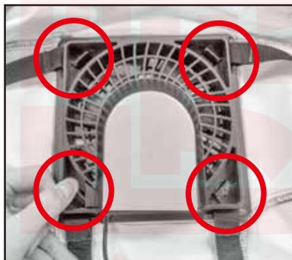
②冷却プレートのツメ 4箇所を固定して、ユニットを固定します。
