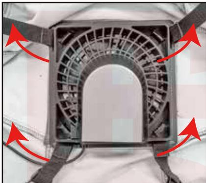
⑧ツメを外したら、冷却プレートを上に持ち上げ、外します。
