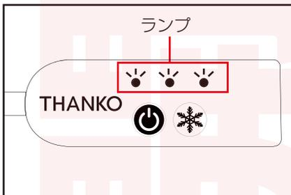
④電源が入り、ランプが全て点灯します。冷却が始まります。
