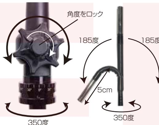
カメラ稼働ダイヤルを回すと2方向にカメラの先端部が曲がります。カメラ稼働ダイヤルの真ん中にあるダイヤルロックを時計回りに回すと、先端カメラの角度を固定できます。カメラ回転ダイヤルを回転させることにより、カメラ自体の向きを変える事が出来ます。350度回転します。
