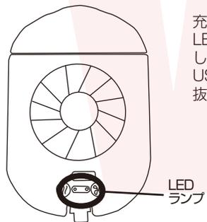
充電が完了しましたらLEDランプが常時点灯します。USBケーブルを抜いてください。
