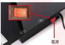
電源プラグを差し込みましたら、本体側面の電源スイッチを押してください。電源スイッチには「— ○」と表示がありますので、「—」の方へ押すと電源が入ります。
