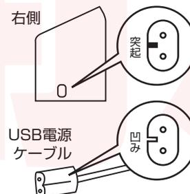
USB電源ケーブルのUSB端子側をモバイルバッテリー(別途ご用意ください)やAC電源に接続します。
