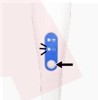
【電源 ON】電源ボタンを長押しすると、電源が ON になり電源 LED が青く点滅します。
