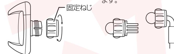
③スマートフォンホルダーをアーム(長/短)にカチッと手応えがあるまで差し込み、固定ねじを回して固定します。
