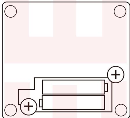
本体背面の電池蓋に爪をかけて、電池蓋を外します。
