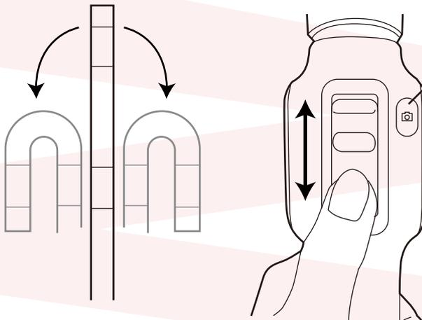
カメラ操作ダイヤルを上下に動かすと、先端のカメラを曲げることができます。
