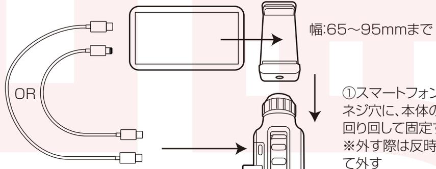
①スマートフォンホルダーのネジ穴に、本体のネジを時計回り回して固定する
