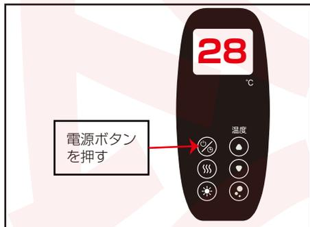
①電源ボタンを4秒以上押します。電源が切れ、リモコンに「OF」と表示されます。
