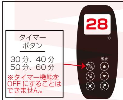
起動中に電源ボタンを押すと、タイマーの時間調整ができます。押すたびに30、40、50、60分と設定時間を変えることができます。タイマーの初期設定は30分になっています。
