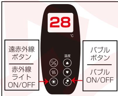
遠赤外線ボタンを押すと遠赤外線ライトが点灯します。OFFにする時はもう一度ボタンを押してください。
