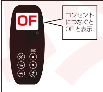
プラグをコンセントに差し込むと、リモコン画面に「OF」と表示されます。
