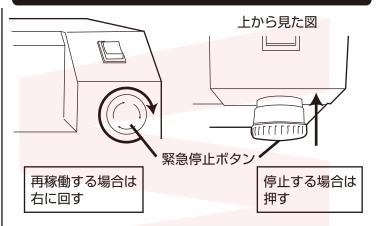
髪が引き込まれたなど、緊急の場合には、緊急停止ボタン を押してください。動作が停止します。
