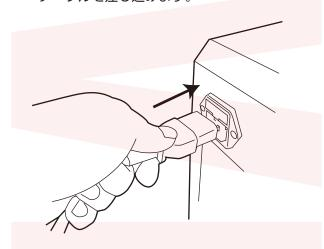
アース設置は安全にご使用いただくために、必ず取り付けてください。接地抵抗値 100 Ω以下であること を確認してください。
