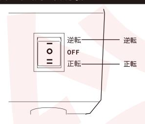
電源スイッチを【逆転】側にして、ダンボールを引っ 張り出してください。ダンボールを取り出せない場合 は、逆転・正転スイッチを交互に押して排出してくだ さい。
