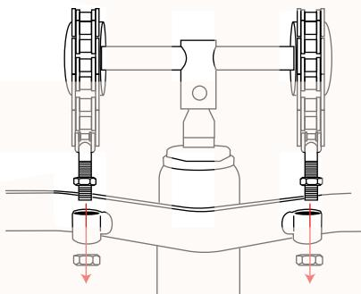
⑦留め金を再度ネジに差し込み、先端を開いて固定します。
