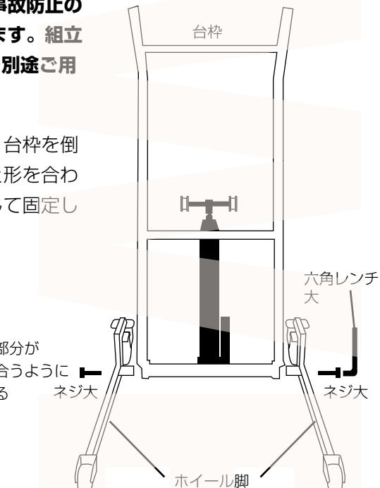
②リフトユニットを取り付けます。ハンドルの上から通し下まで下ろします。リフトユニットは大変重いので、取扱いに十分気を付けてください。
