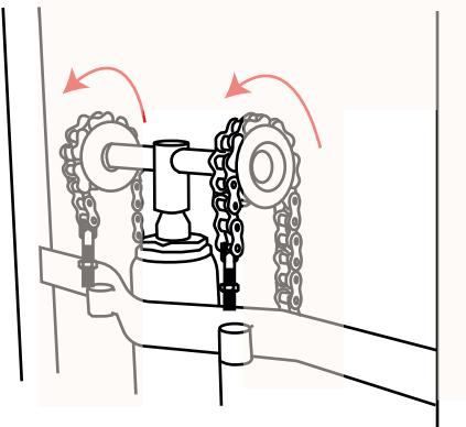
⑥台枠の穴にチェーン先端のネジを通して、外したナットを留めます。
