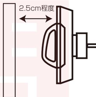
開センサーから約2.5cm以下の距離で反応します。また開センサーの真正面にスマートフォンがないと反応しません。
