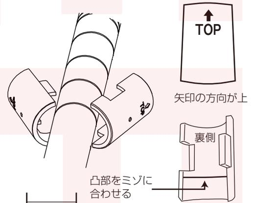
スリーブの片方をポールのミゾに合わせてセットし、もう片方を取り付けます。※上下に動かないか確認してください。※セットされた状態でもすき間があります。
