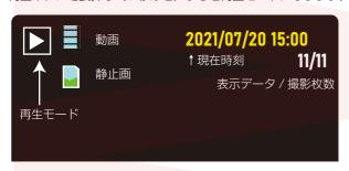
▲▼でデータの選択、OK/再生ボタンで動画の再生を行います。 MENU ボタンを押すと削除画面が表示されます。 現在表示中のデータを削除する場合は「1 つを削除する」 撮影したデータ全てを削除する場合は「すべて削除」を選択してください。 MENU ボタンを押すとキャンセルすることができます。
