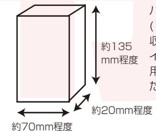
バッテリーポケット(100×160mm)に収まるサイズのモバイルバッテリーを使用することを推奨いたします。
