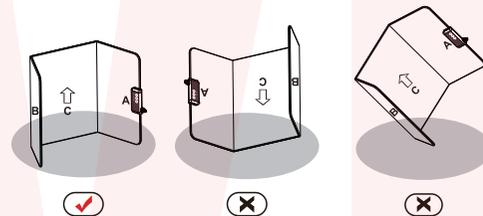
②ヒーターパネルの左右に脚を取り付けます。脚の溝にヒーターパネルを上から挟み込んでください。
