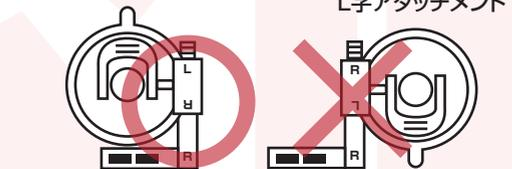
※吸盤の取付け向きにお気をつけください。アタッチメントに印字されているローマ字と、吸盤のローマ字が合わるように取付けてください。
