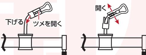
①取付けフックの両側のツメを開き、取付けフックを押し下げます。②U字フックの両側を開いて取り外してください。
