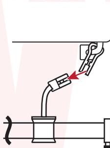
⚠ 落下防止のため、必ずフックと吸盤の2種類(合計4箇所)で取付けてください。
