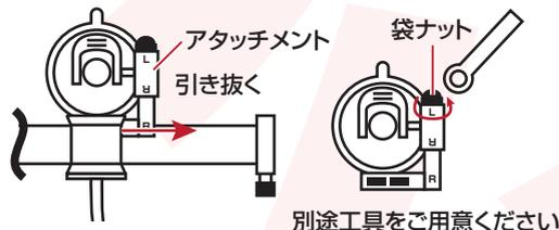
①吸盤のアタッチメントを本体から引き抜きます。②アタッチメント上部の袋ナットをメガネレンチやスパナ(別途ご用意ください)で取り外します。
