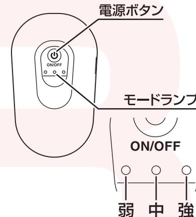
電源ボタンを押すごとに弱→中→強とモードが変わり、空気の入り方が変わります。強の状態でもう一度押すと電源が切れます。動作中に電源ボタンを長押しすることでも電源を切ることができます。
