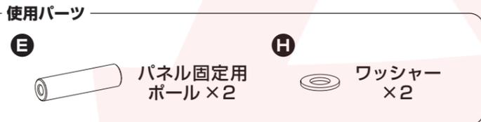
右図を参考に、有孔パネルの内側にあるねじにワッシャー・パネル固定用ポールの順に差し込み、パネル固定用ポールを矢印の向きに回してしっかりと固定してください。
