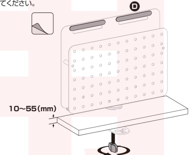
⚠ ※デスクフレームなどの突起物がない平らで頑丈な天板に取り付けてください。※天板に締め跡が残る場合がございますので、気になる方は天板を養生してから固定してください。※クランプは必ず奥まで差し込んでください。※取り付け後は本体を少し揺すり、ずれたり外れたりせず、しっかりと固定されているかを必ずご確認ください。
