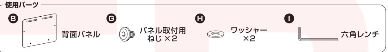
背面パネルの下部にある2箇所の突起が、有孔パネルの溝にはまるように上から差し込みます。背面パネルにあるねじ穴と、前項で取り付けたパネル固定用ポールの位置を合わせ、ワッシャー・パネル取付用ねじの順に差し込みます。右図を参考に、パネル取付用ねじを六角レンチで矢印の向きに回し、しっかりと締めてください。
