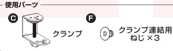
下図を参考にクランプねじを矢印の方向に回し、クランプ部分を最大限まで広げます。有孔パネルの下部にあるねじ穴とクランプのねじ穴の位置を合わせ、クランプ連結用ねじを3箇所差し込みます。六角レンチを用いて、クランプ連結用ねじを矢印の向きに回し、しっかりと締めてください。
