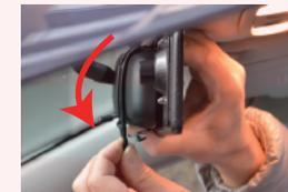
②ルームミラーを挟み込むようにして、本体のクリップ部に取付バンドを付ける。
