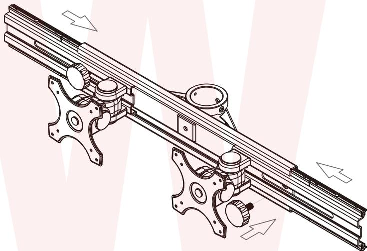
横軸部に取り付けネジで取り付けして下さい。
