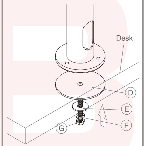
机に取り付け穴がある場合か、穴あけ加工が可能な場合は、軸部を上図の様に取付けて下さい。
