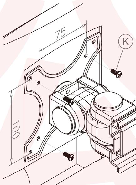
付属ネジでモニターを取り付けて下さい。
