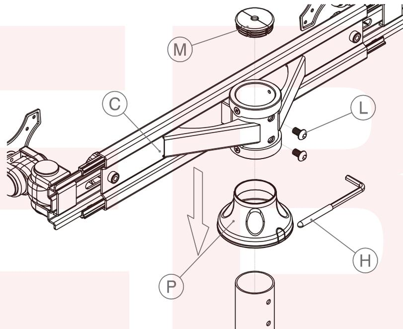
横軸部を軸部に図のように取り付けて下さい。
