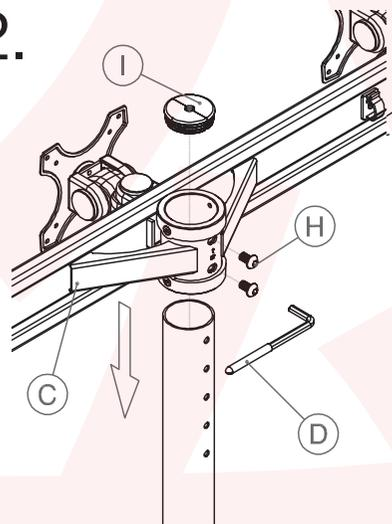
アームを上図のように差し込んで、H-ネジ2本で、アームを固定してください。ボール上部のキャップ(I)を取り付けて下さい。アームの高さを調整する時は、取り付け位置で調整してください。
