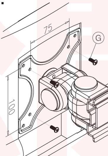
ネジ4個を使って、液晶モニタの背面にVESAプレート固定します。
