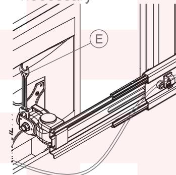
根本部の上段のボルトを付属品のレンチでゆるめると、根元の角度を調整することができます。角度が決まりましたら、ボルトをしっかりとめて固定してください。ケーブルは付属の留め具に取り回して下さい。
