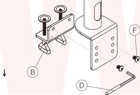
天板の厚さにより、六角レンチでクランプの高さを調整して机の天板に挟み込むようにしっかりと取り付けてください。
