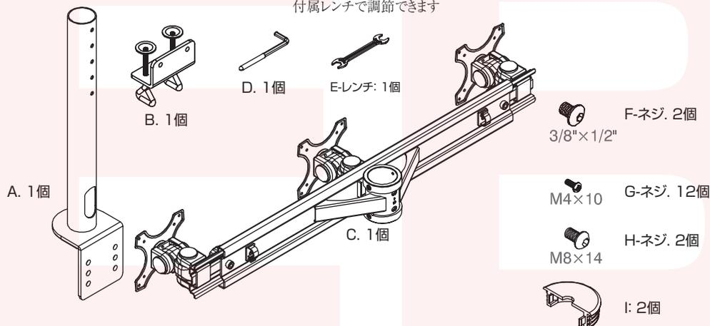
本モニターアームは、VESA規格液晶モニターに対応しており、75mm/100mmVESA対応モニターをそのまま取り付けいただけます。
