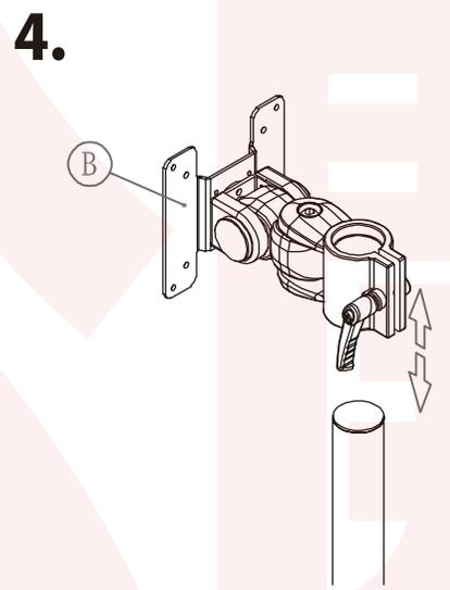
アーム部(B)をポールに押しこんで下さい。高さを調整し、レバーで締め込んで固定して下さい。
