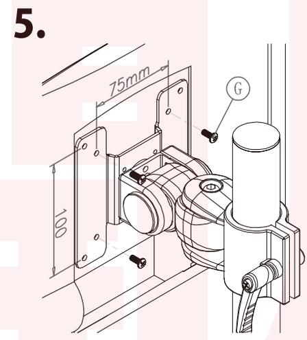
液晶モニター取り付け部分と液晶モニターを付属のネジ4本(C)で固定します。(VESA規格75mm × 75mmまたは100mm × 100mmへ取り付け可能)
