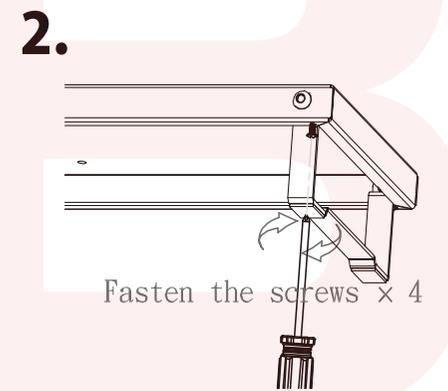
足部の固定をするため、付属ネジ(G)4本を取り付けて固定して下さい。
