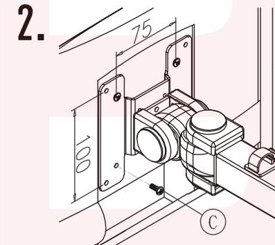
液晶モニター取り付け部分と液晶モニターを付属のネジ4本(C)で固定します。(VESA規格75mm × 75mmまたは100mm × 100mmへ取り付け可能)
