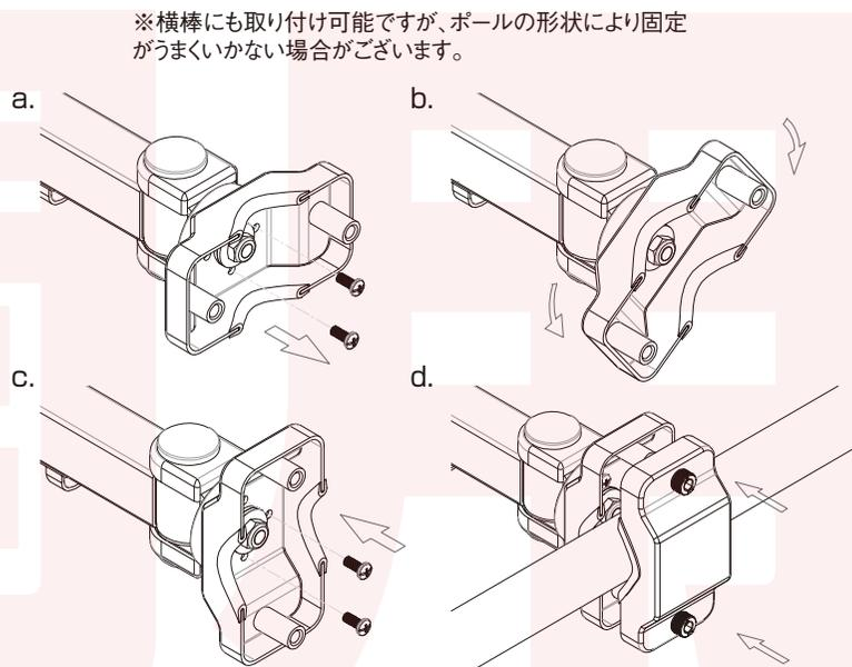
本体取り付け部の内部のネジを外し、90度回して固定します。
