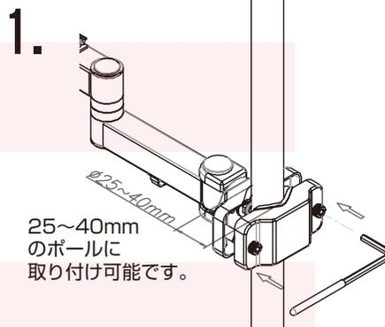
付属のレンチ(A)で、取り付け部をいったん外し、机やスチールラックのポール部に、挟み込み、高さをお好みの位置に調整して、付属レンチで固定します。
