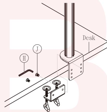
図のように、クランプ部を組み立て、机の天板に取り付けて下さい。
