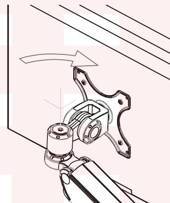
モニターの左右角度調整時、堅い場合は付属レンチで緩めて、モニターの角度調整を行って下さい。
