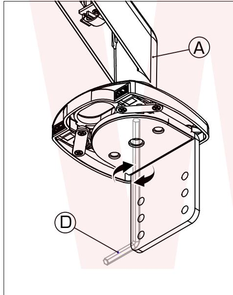
モニターアーム本体にクランプ部をネジで取り付け、机などに固定します。机の厚みにより3ヶ所固定位置が選べます。
