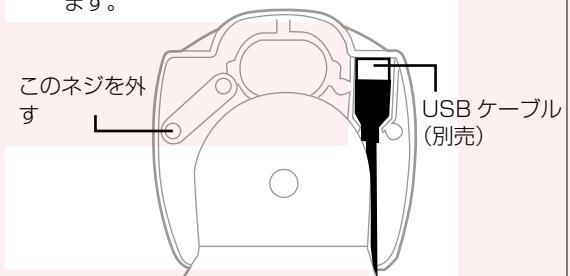
③金具を元に戻し、ネジを取り付けます。
