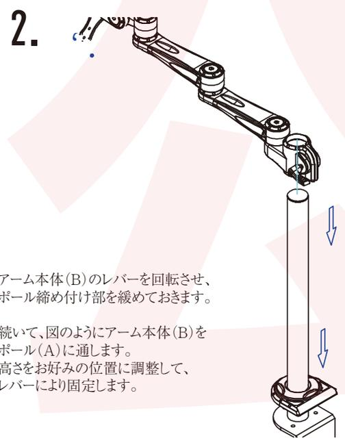
アーム本体(B)のレバーを回転させ、ポール締め付け部を緩めておきます。
