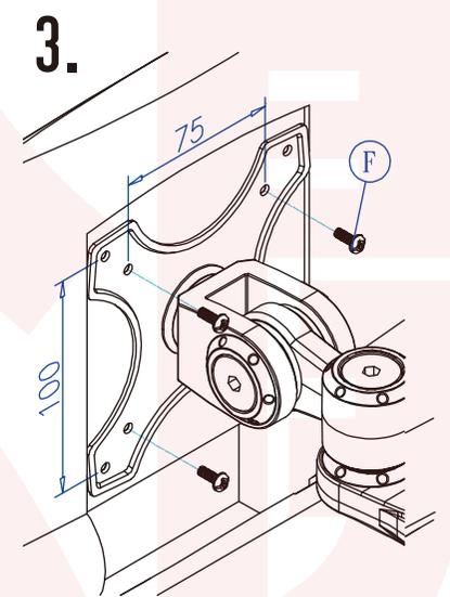
液晶モニター取り付け部分と液晶モニターを付属のネジ4本(M)で固定します。(VESA規格75mm × 75mmまたは100mm × 100mmへ取り付け可能)
