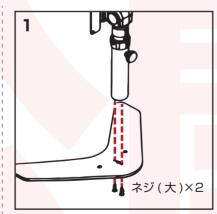
プラスドライバー(別売)をご用 モニター裏のネジ位置に合わせ、 意の上、ネジ(大)×2をスタン ネジ(小)×4をスタンドの裏側 ドの下側から入れ、共締めします。から共締めします。
