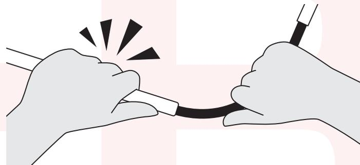
⚠ フレキシブルアームを曲げる際は、アーム部分を持ちながら曲げるようにしてください。破損の原因になります。
