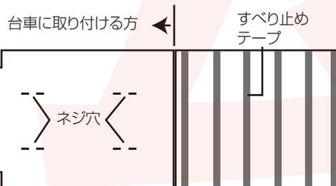
③スロープを下図のように階段台車の台座に被せます。
