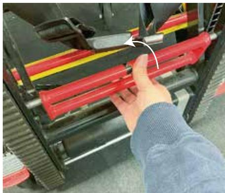
②キャタピラロックバー2本の内の上を前方に倒すと、ロックが外れゴムキャタピラ内側のレール上に入ります。
