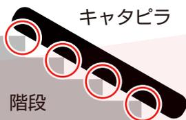
階段の角に常にキャタピラが接地しているように移動してください。
