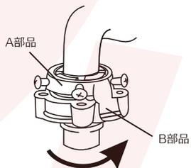
B部品を反時計回りに回し、A部品に固定します。その際、蛇口に密着させ漏れが無いか確認してください。
