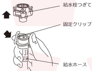
給水栓つぎてはA部品、B部品に分かれています。A部品を蛇口に取り付けた後、B部品をねじ込んでください。その際、A部品のネジとB部品の間に4mm程度の間隙を開けて固定してください。
