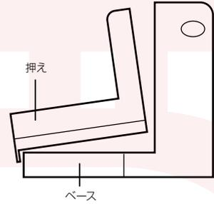
**2** ベースの凹に押えの凸が合うように、押えを倒せば取り付けが完成です。
