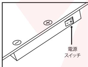
電源プラグを差し込みましたら、本体側面の電源スイッチを押してください。電源スイッチには「一 ○」と表示がありますので、「一」の方へ押しと電源が入ります。
