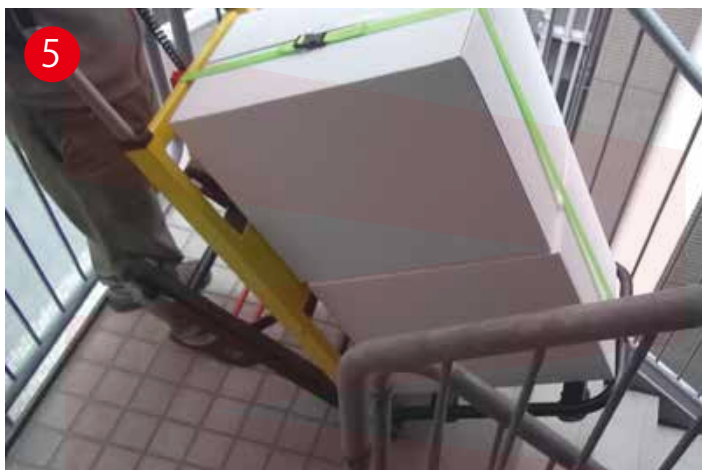
5 走行ベルトの端が地面に付くまで全体を少し倒します。
