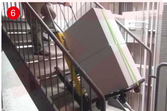
6 昇るボタンを押すと走行ベルトが動き出し、階段をのぼります。
