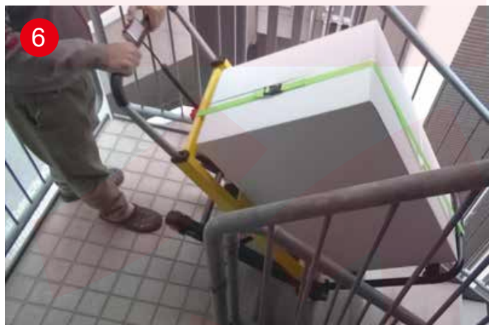
6 降るボタンを押してすこしづつ走行ベルト全体が階段に付くように倒しながら進めます。
