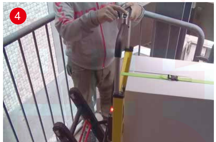
④ コントローラーの電源を入れます。
