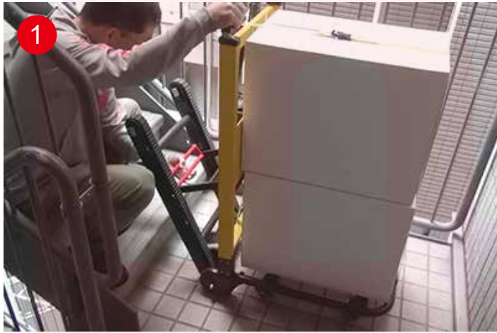
階段に合わせて、走行ベルトの角度を調節します。
