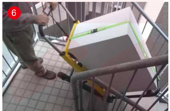
⑥ 降るボタンを押してすこしづつ走行ベルト全体が階段に付くように倒しながら進めます。
