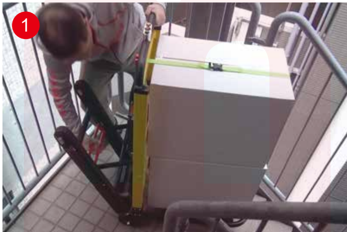
① 階段に合わせて、走行ベルトの角度を調節します。
