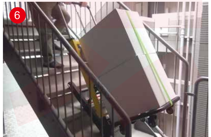
昇るボタンを押すと走行ベルトが動き出し、階段をのぼります。
