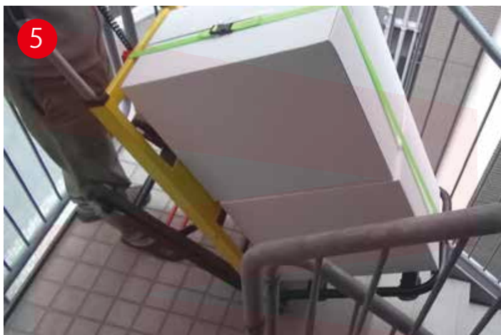
⑤ 走行ベルトの端が地面に付くまで全体を少し倒します。
