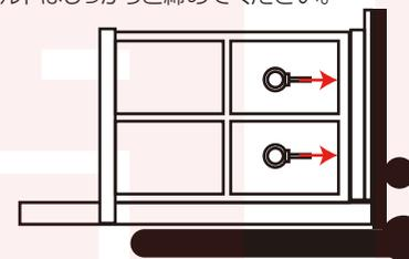
⑤台座プレートの蝶ナットをしっかり締めした後、台車を起こします。
