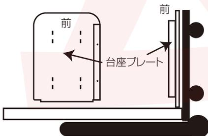
③台座プレートの8か所の穴にネジを通し、プレート小を挟んで蝶ナットで固定します。
