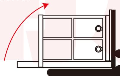
⑥台車の支柱にアタッチメントを取り付けます。
