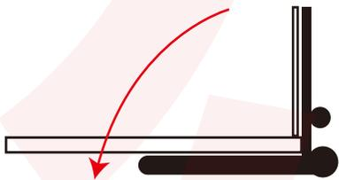
②台座プレートの凸部がある方が上になるように、電動台車の台座に合わせます。
