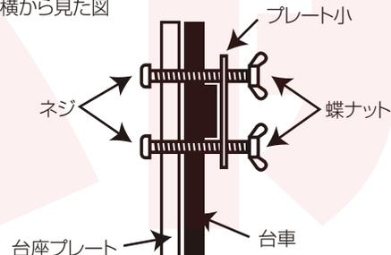
④台座プレートにアイボルトでアタッチメントを取り付けます。穴が合わない場合は、台座プレートの位置を調整してください。
