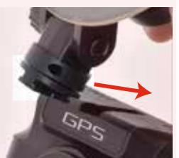
吸盤をガラス面にしっかりとくっつけて、吸盤下にあるツマミをロック側に回します。落下しないか確認して下さい。
