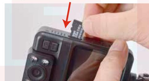
カードを抜く時は、カードを爪先で押し込むと、カードが出てきますので、掴んで抜いて下さい。
