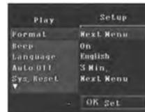
4. Power&ビデオON/OFFスイッチを押して、再生タブと設定タブを切り替え可能です。Down(下)、Up(上)、Enter(決定)で設定や表示の操作ができます。
