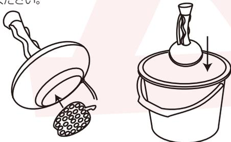
③本体をバケツの側面に張り付けると、水流が強くなりますが、バケツから水があふれる可能性があります。その場合はフタのあるバケツを利用するか、ラップなどでバケツの口を塞いでください。
