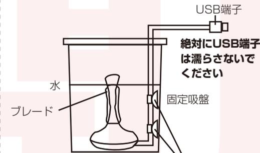
ケーブルは固定吸盤でバケツの側面にしっかりと固定してください。たるませた状態で洗濯するとブレードにひっかかり、洗濯物に絡まったりする可能性があります。
