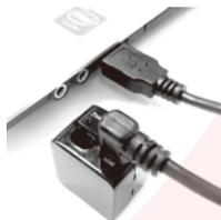
左図のように本体USB差込口に付属のUSBケーブルを繋ぎ、反対側の端子をパソコンやUSB-ACアダプター(別売)などに接続してください。
