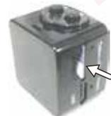
電源を切った状態で、左図のようにmicroSDスロットにmicroSDカードを差し込みます。カードの向きは印刷面がレンズとは逆になります。奥までしっかり差し込んでください。
