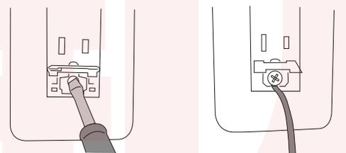
(1) マイナスドライバー等でアース端子のフタを開けアース線取付用のネジをゆるめます。
