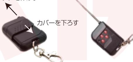
リモコンの電池がなくなった場合は、ネジを外し12V 23Aのアルカリ電池を新しく入れて下さい。
