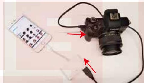
本体の USB 2.0 Type-A (デジカメ入力) ポートにお手持ちの USB ケーブル (別売) を接続してください。反対側のコネクタをデジカメに接続し電源を入れてください。DCF 規格に対応したデジカメが接続された場合、スマホ / タブレットに画像の取り込み画面が表示されます。
