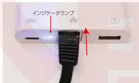
LAN ケーブル (別売) を RJ45 (Ethernet) ポートに接続します。反対側のコネクタがルーターなどに接続されている場合、LAN ケーブルを介したインターネット接続が可能になります。
