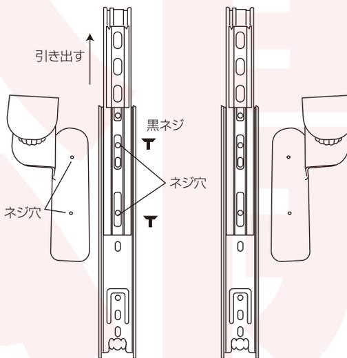
④ クランプが天板の外側に位置するように組み立てます。クランプ部の左右を確認してください。
